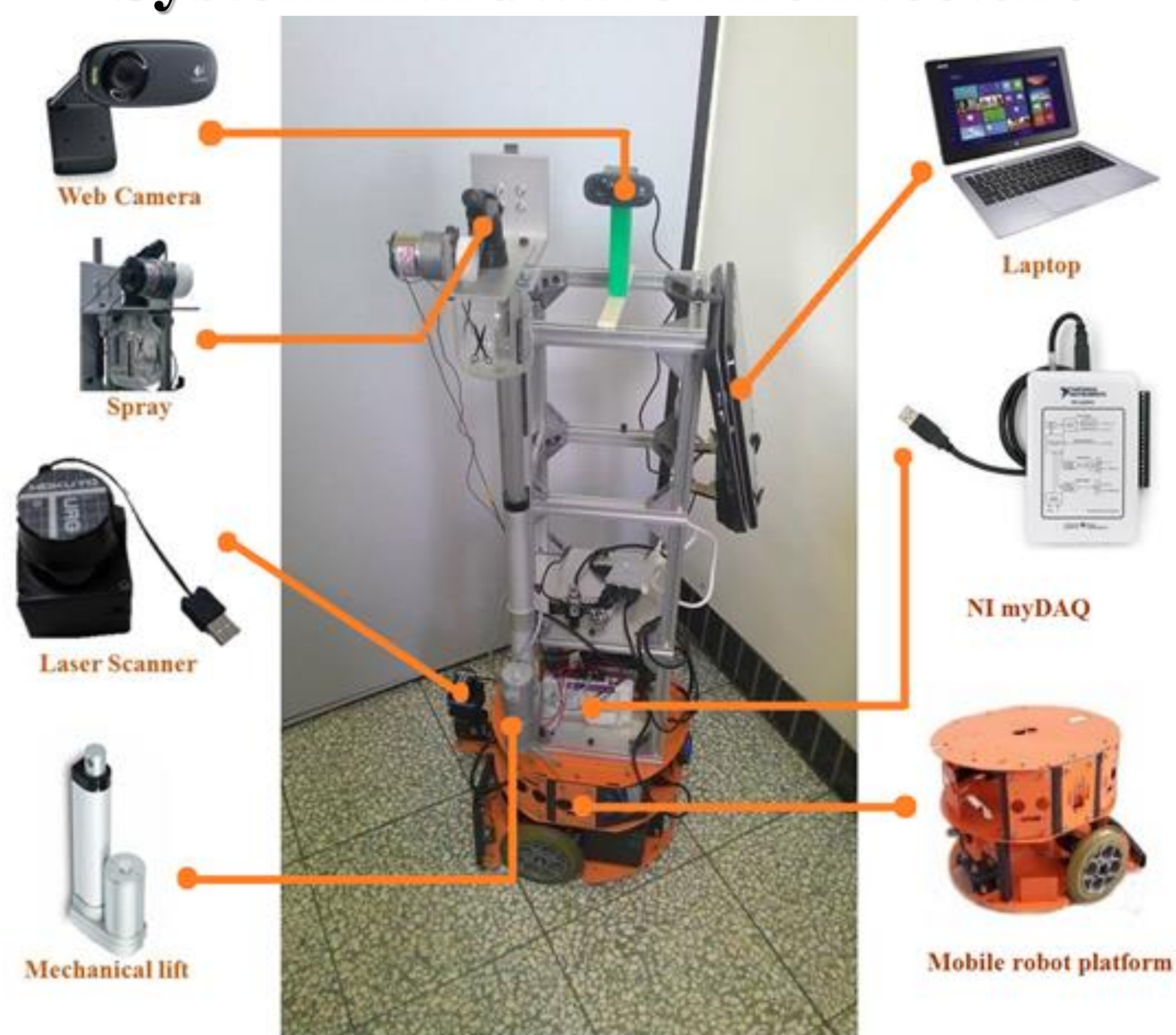
Fig. 1. 機器人平台架構與外部感測器
